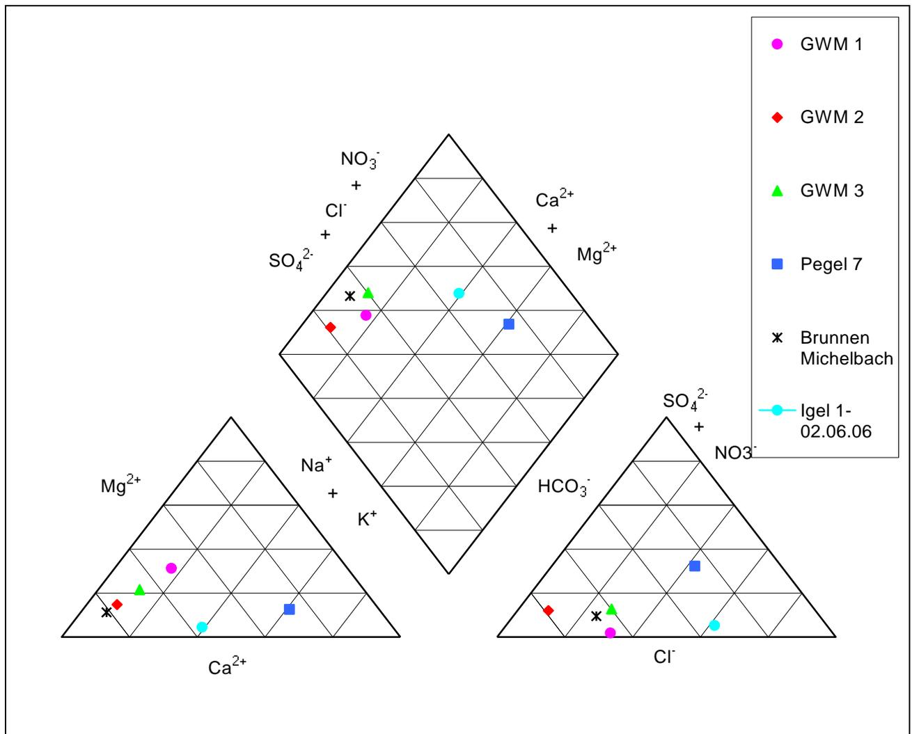
Abb. 1: Darstellung der Ionenverhältnisse im Piper-Diagramm für den 26.11.2010 sowie für die Erstbeprobung von GWM Igel 1 (02.06.2006).
