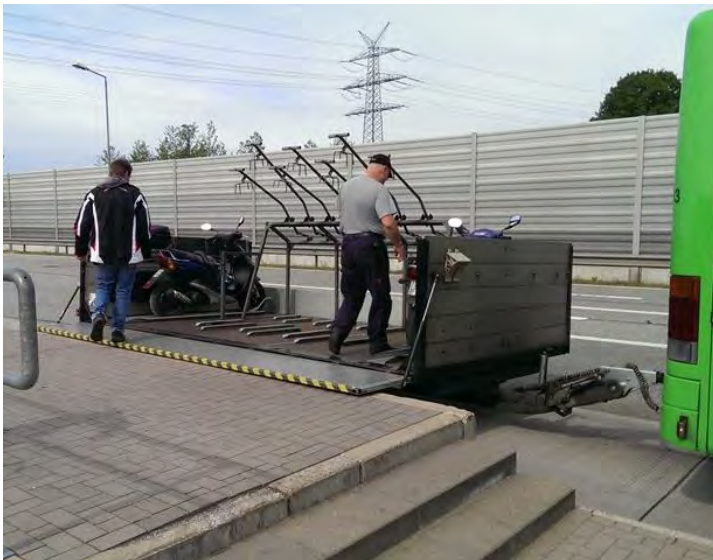
Abbildung 138: Verloaderampe für einen Fahrradanhänger 44
