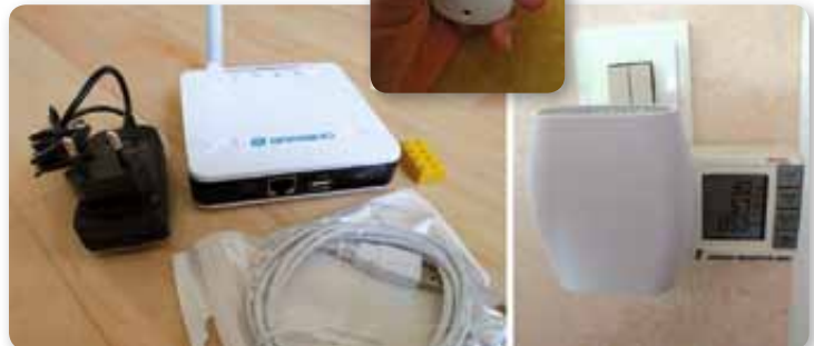
Legende zur Abbildung: Die beiden verfügbaren LoRaWAN-Gateways und ein GPS-Logger mit Alarmknopf.
