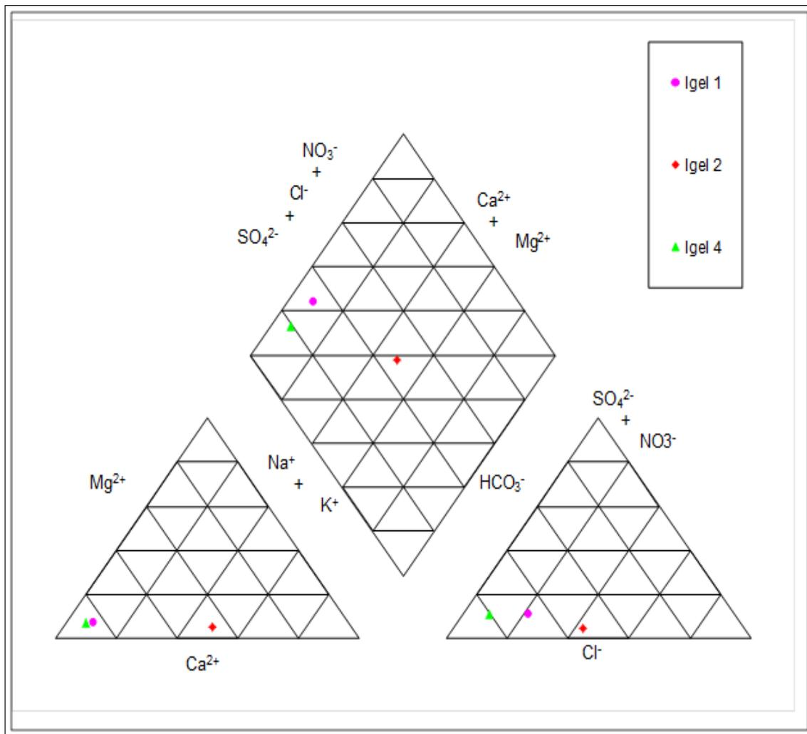
Abbildung 3: Darstellung der Ionenverhältnisse im Piper-Diagramm für den 26.09.2016 - Bereich Bauschuttablagerung Igelpfuhl (Igel 2 und Igel 4 unter Vorbehalt wegen Schöpfprobe)
