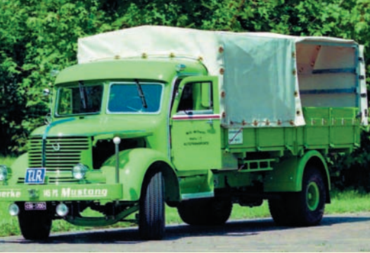
Deutschlands größtes Modellauto ist auch zu bestaunen: Mit einem Maßstab von 1 : 4,2 sprengt der Krupp Mustang, Baujahr 1951, jegliche Dimensionen herkömmlichen Modellbaus. Das Modell misst 2,05 Meter in der Länge, ist 60 cm breit und 80 cm hoch. Sein Gewicht liegt samt eingebautem Elektromotor bei 220 Kg.
